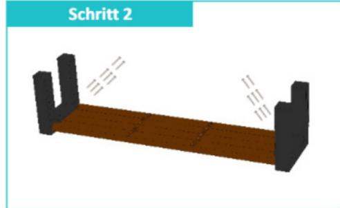
Verschrauben Sie die Bankfüße mit jeweils 8 Schrauben ( $\varnothing$ 6x60mm Senkkopf) mit dem Sitzelement.
