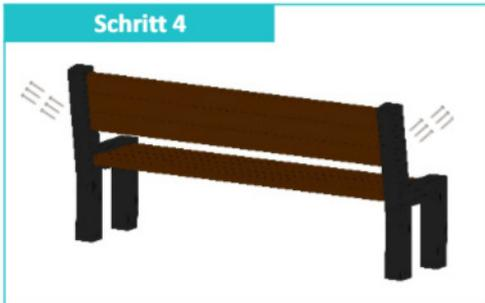
Verschrauben Sie anschließend Bankbohlen in einem Abstand von 3mm mit insgesamt 12 Schrauben ( $\varnothing$ 6x60mm Pan-Head). Achten Sie darauf, dass die Bank sicher im Boden verankert wird.
