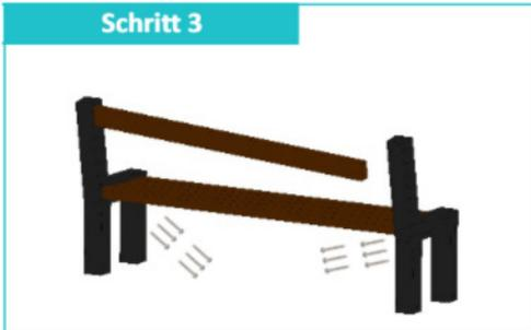
Richten Sie die Bank nun auf. Anschließend schieben Sie die 3 Rückenbohlen, wie auf dem Bild zu sehen, in die dafür vorgesehene Öffnung in der Rückenlehne.
