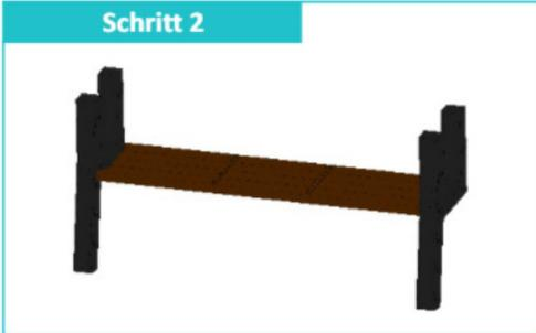
Verschrauben Sie die Bankfüße mit jeweils 8 Schrauben ( $\varnothing$ 6x60 mm Senkkopf) mit dem Sitzelement.
