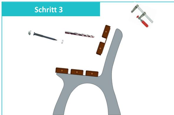
Verfahren Sie bei der Montage der Rückenlehne entsprechend Schritt 2. Die Rückenlehne schließt bündig mit der Oberkante der Bankfüße ab.
