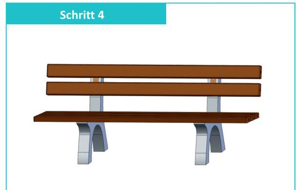
Nach der Endmontage werden die Schraubköpfe mit den Kappen abgedeckt. Achten Sie dabei auf ein deutliches Klicken beim Einrasten der Kappen auf dem O-Ring.
