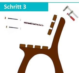
Verfahren Sie bei der Montage der Rückenlehne entsprechend Schritt 2. Die Rücklehne schließt bündig mit der Oberkante der Bankfüße ab.
