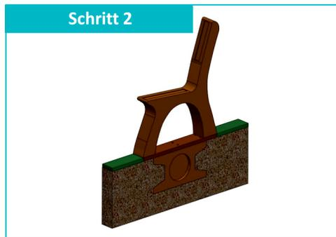
Nach der Montage wird das Fundament vorbereitet. Hierbei ist die korrekte Tiefe und Breite des Fundaments zu beachten. Die Bankfüße sollen mit der umgebenden Fläche eben aufgestellt werden.
