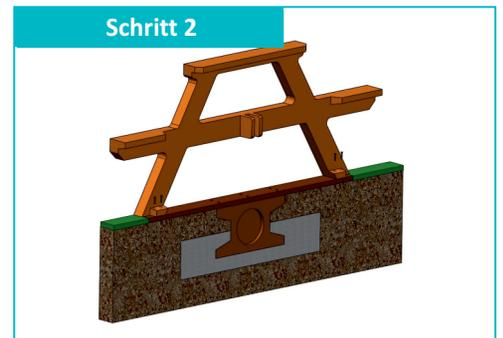
Nach der Montage wird das Fundament vorbereitet. Hierbei ist die korrekte Tiefe und Breite des Fundaments zu beachten. Die Bankfüße sollen mit der umgebenden Fläche eben aufgestellt werden.
