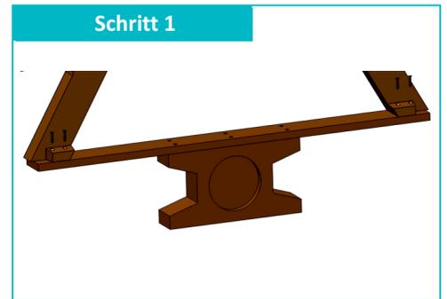
Verschrauben Sie die Bodenanker mit den beiliegenden Schrauben entsprechend der Skizze. Bohren Sie zunächst mit einem 6mm Spiralbohrer vor.
