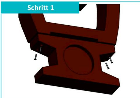
Verschrauben Sie die Bodenanker mit den beiliegenden Schrauben entsprechend der Skizze. Bohren Sie zunächst mit einem 6mm Spiralbohrer vor.
