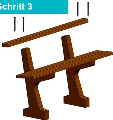
Richten Sie die Sitzauflage bündig zur hinteren Kante Bandfußes aus und verschrauben Sie diese mit den Schrauben 6 x 120 cm durch die Vorbohrungen (je Bankfuß 2 Schrauben).
