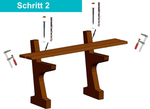
Setzen Sie das vormontierte Sitzelement auf die Füße auf. Die Verbinders in den Aussparungen ausrichten und mit den Schrauben (8 x 70 mm) fixieren.
