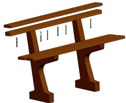
Montieren Sie als nächstes die Bankbohle auf dem Sitzbrett, bündig zur vorderen Kante, durch die vorgebohrten Löcher von unten (6 Schrauben 6 x 70 mm).
