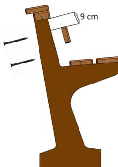
Richten Sie die Rückenbohlen am Fuß aus (9cm von der Unterkante der Sitzauflage) und verschrauben Sie die Bohlen durch die vorgebohrten Kanäle. Je Bankfuß 2 Schrauben (6x120 mm).
