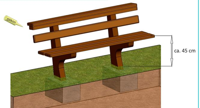
Bringen Sie die Bank in ein Betonfundament und fixieren Sie diese während der Trockenphase des Betons. Erst nach vollständiger Aushärtung kann die Bank belastet werden. Die Schraubenköpfe im Rückenbereich werden mit Silikon abgedeckt.
