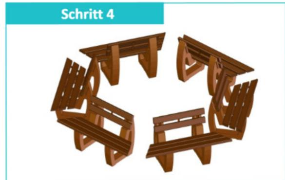
Bauen Sie die 5 weiteren Rundbänke nach den Schritten 1-3 zusammen und positionieren diese dann in einem Sechseck mit den Sitzflächen nach außen.
