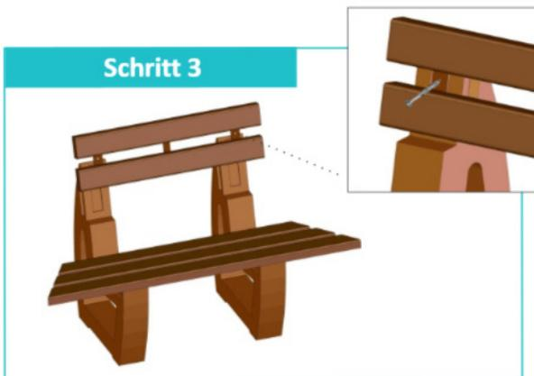
Die Rückenlehne schließt bündig mit der Oberkante der Bankfüße ab. Die Verbinderr in den Aussparungen ausrichten und mit 2 Schrauben ( $\varnothing$  8x70 mm) befestigen. (Die Schrauben werden mit Ringen unterlegt) Anschließend werden die Schraubköpfe mit den Kappen abgedeckt.
