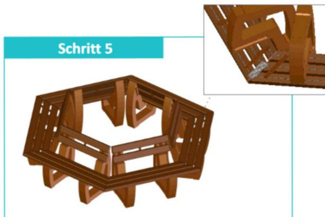
Um die Lochbleche zu montieren stellen sie die Rundbänke zusammen und verschrauben Sie die Lochbleche von unten mit je 6 Schrauben ( $\varnothing$  4,5x35 mm) in den Ecken.
