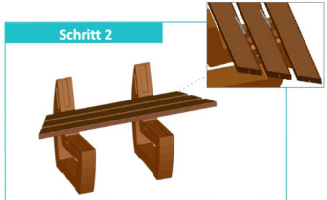
Legen Sie das Sitzelement auf den Bankfüßen auf. Die Verbinderr in den Aussparungen ausrichten und mit 4 Schrauben ( $\varnothing$  8x70 mm) befestigen. (Die Schrauben werden mit Ringen unterlegt) Anschließend werden die Schraubköpfe mit den Kappen abgedeckt.
