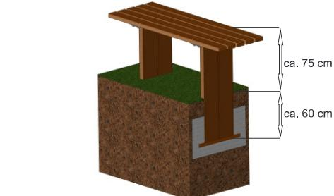
Bringen Sie den Tisch in ein Betonfundament ein und fixieren Sie diesen während der Trockenphase des Betons. Erst nach volliger Aushärtung kann der Tisch belastet werden. Die Tischhöhe von Oberkante Boden beträgt ca. 75 cm.
