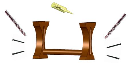
Mit 4,5mm Spiralbohrer vorbohren. Stabilisator an jedem Tischfuß mit 2 Schrauben (6x140mm) befestigen. Mit Silikon die Schrauben abdecken.
