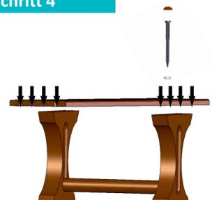
Befestigen Sie das Tischbrett mit den gelieferten Schrauben am Tischfuß. Legen Sie den O-Ring mit der glatten Seite Richtung Tischfuß unter die Schrauben. Die Kappen werden über die Schraubköpfe gestülpt und angedrückt.
