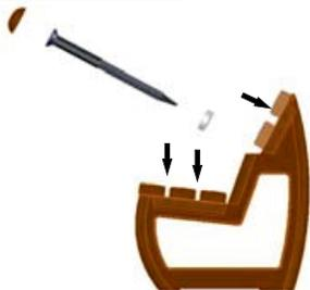
Befestigen Sie das Sitzbrett mit den gelieferten Schrauben am Bankfuß. Legen Sie den O-Ring mit der glatten Seite Richtung Bankfuß unter die Schrauben. Die Kappen werden über die Schraubköpfe gestülpt und angedrückt.
