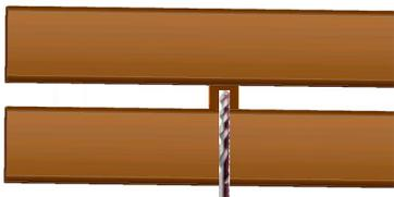
Mit Spiralbohrer ( $\varnothing = 6\text{mm}$ ) durch die Löcher der Verbindungseisen Vorbohrungen in den Bankfüßen vornehmen. (4x Sitzelement - 2x Rückenelement)
