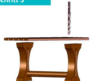
Mit Spiralbohrer ( $\varnothing = 6\text{mm}$ ) durch die Löcher der Verbindungseisen Vorbohrungen in den Tischfüßen vornehmen. (8x Tischelement)
