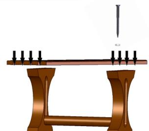
Befestigen Sie das Tischbrett mit den gelieferten Schrauben (8x70mm) am Tischfuß. Legen Sie den O-Ring mit der glatten Seite Richtung Tischfuß unter die Schrauben. Die Kappen werden über die Schraubköpfe gestülpt und angedrückt.
