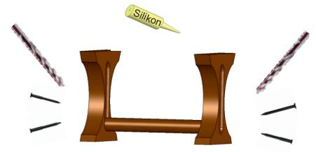
Mit 4,5mm Spiralbohrer vorbohren. Stabilisator an jedem Tischfuß mit 2 Schrauben (6x140mm) befestigen. Mit Silikon die Schrauben abdecken.
