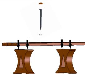
Befestigen Sie das Sitzbrett mit den gelieferten Schrauben am Bankfuß. Legen Sie den O-Ring mit der glatten Seite Richtung Bankfuß unter die Schrauben. Die Kappen werden über die Schraubköpfe gestülpt und angedrückt.
