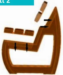
Die Verbindungseisen am Sitz und Rückenbrett werden passgenau in die Vertiefungen am Bankfuß eingelegt.
