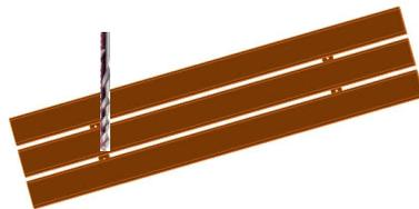
Mit Spiralbohrer ( $\varnothing = 6\text{mm}$ ) durch die Löcher der Verbindungseisen Vorbohrungen in den Bankfüßen vornehmen. (4x Sitzelement)
