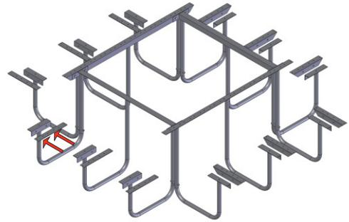
Verschrauben Sie die mitgelieferten Winkelprofile für die Sitzbelegung mit dem Bankfuß. Verwenden Sie hier bitte auch die „Sechskantschraube DIN EN 933 - M8 x 30“ mit passenden U-Scheiben und Muttern.
