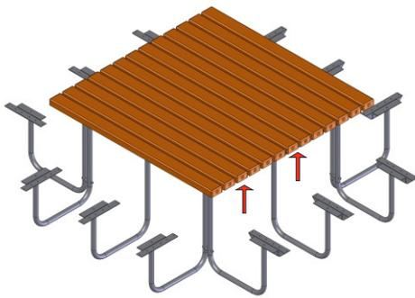
Legen Sie nun die Bankbohlen der Tischfläche in einem Abstand von ca. 16,5mm zueinander auf und richten diese mittig zum Bankfuß aus. Verschrauben Sie anschließend jede Bohle von unten mit je 4 Spanplatten-schrauben  $\varnothing 6 \times 40 \text{mm}$  Pan-Head.
