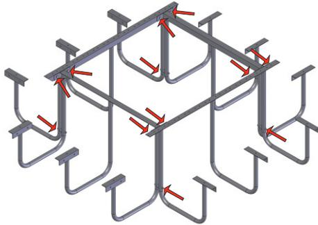
Stellen Sie die Elemente der Bankfüße auf einer ebenen Fläche auf und verschrauben diese im oberen Bereich mit 8 Stück „Sechskantschraube DIN EN 933 - M8 x 30“ und passenden U-Scheiben und Muttern durch die vorgebohrten Löcher. Verschrauben Sie die Bankfüße anschließend im unteren Bereich durch die vorgebohrten Löcher mit 4 Stück „Flachrundschaube DIN 603 M8x90“ und passenden U-Scheiben und Muttern.
