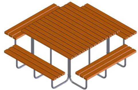
Legen Sie nun Die Bankbohlen der Sitzflächen auf dem Bankfuß auf und richten diese mittig zur Auflage und zur Tischfläche aus. Der Bohlenabstand beträgt hier ca. 25mm. Verschrauben Sie Anschließend jede Bohle von unten mit je 6 Spanplattenschrauben  $\varnothing 6 \times 40 \text{mm}$  Pan-Head.
