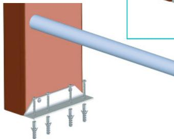
Setzen Sie die Dübel in die Bohrungen ein und ziehen Sie die Winkel an der Bank mit schrauben fest.
