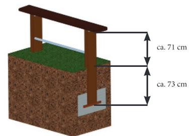
Bringen Sie die Bank in ein Betonfundament ein und fixieren Sie diese während der Trockenphase des Betons.
