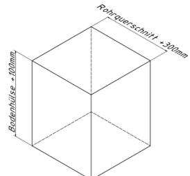
2. In das Fundamentloch ca. 100mm Kiesfüllung
