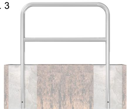
4. Beton hineingeben und ausrichten
