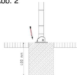
4. Pfosten mittig auf dem Fundament positionieren und Umlegerichtung bestimmen
