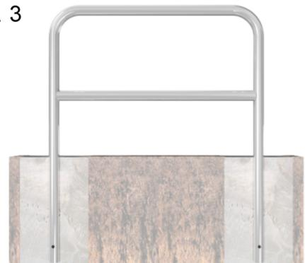
4. Beton hineingeben und ausrichten
