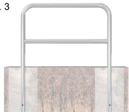
4. Beton hineingeben und ausrichten
