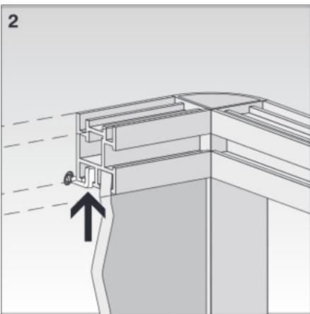
Bei der Wandmontage ist die Vitrine an der unteren Profil-Nut des oberen rückseitigen Profils an den Schraubhaken oder entsprechendem Befestigungs-material aufzuhängen (Bild 2).
